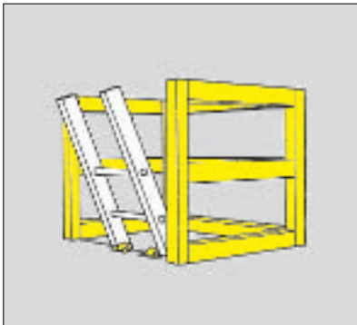
Bild 3: Offene Fußbodenöffnung mit Leiterdurchstieg
